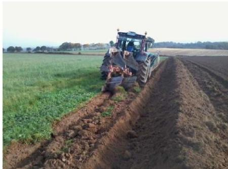
**Réalisation d'ados à la charrue forestière. (5 à 6 passages successifs sont nécessaires pour réaliser l'ouvrage tassé par les passages du tracteur) lorsque l'ados sera réalisé, les abords seront nivelés et un semis de graminée sera réalisé sur l'ados.**
